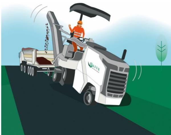
Certaines machines, 35 à 60 et quelques 1m, sont à bandages (à roues). Le poinçonnement de celles-ci est très important. Donc, malgré leur poids plus faible que les machines à chenilles, elles peuvent être bien plus instables sur des sols peu portants, des dalles en béton, des dalles portées, des ouvrages d'art,...
