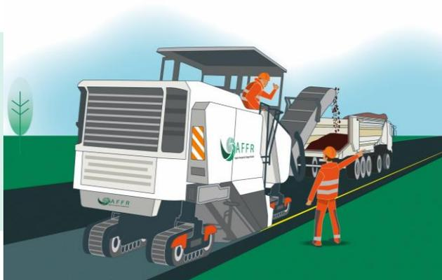
La hauteur des fraiseuses, varie de 3m à plus de 4m. C'est un élément à ne pas oublier lors de la préparation d'un chantier. En effet, certaines zones seront inaccessibles dans des conditions de travail convenable en sécurité : ouvrage, rangée d'arbres avec des branches basses...
