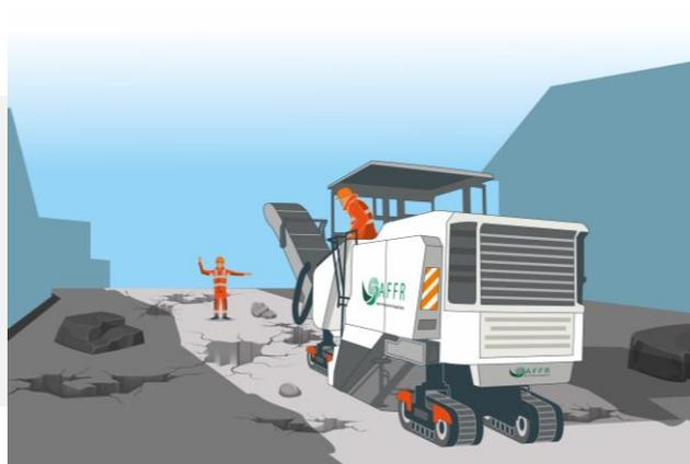
Pour les machines en équipage (chauffeur et régleur), il est impératif que le chauffeur s'assure de la position de son régleur avant tout déplacement la machine.
